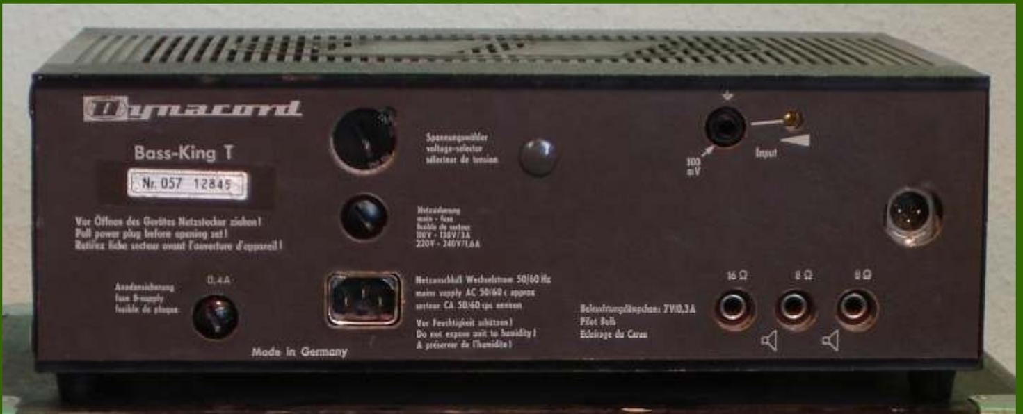
Den Verstärker hatte ich bis vor einiger Zeit als Universal-Verstärker umgebaut und benutzt. Die Transistor-Vorstufe hatte ich ausgebaut und durch Teile aus einem Eminent 2 ersetzt. Ich hatte so zwei Mikrofon-Eingänge, einen Line-Eingang (jeweils mit Effekt-Send-Regler) und einen Effekt-Return-Eingang zur Verfügung.
